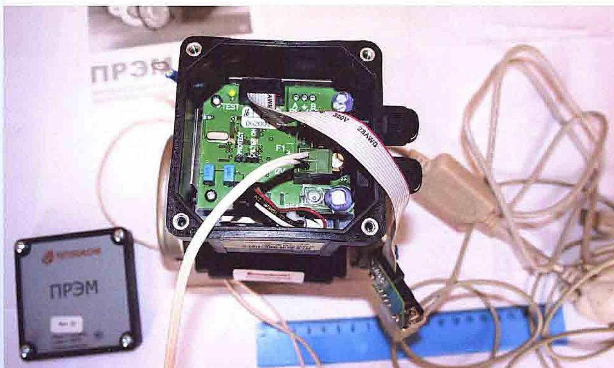
Иллюстрация №6. Увеличенное изображение ПРЕМ со снятой лицевой панелью измерительного блока.
